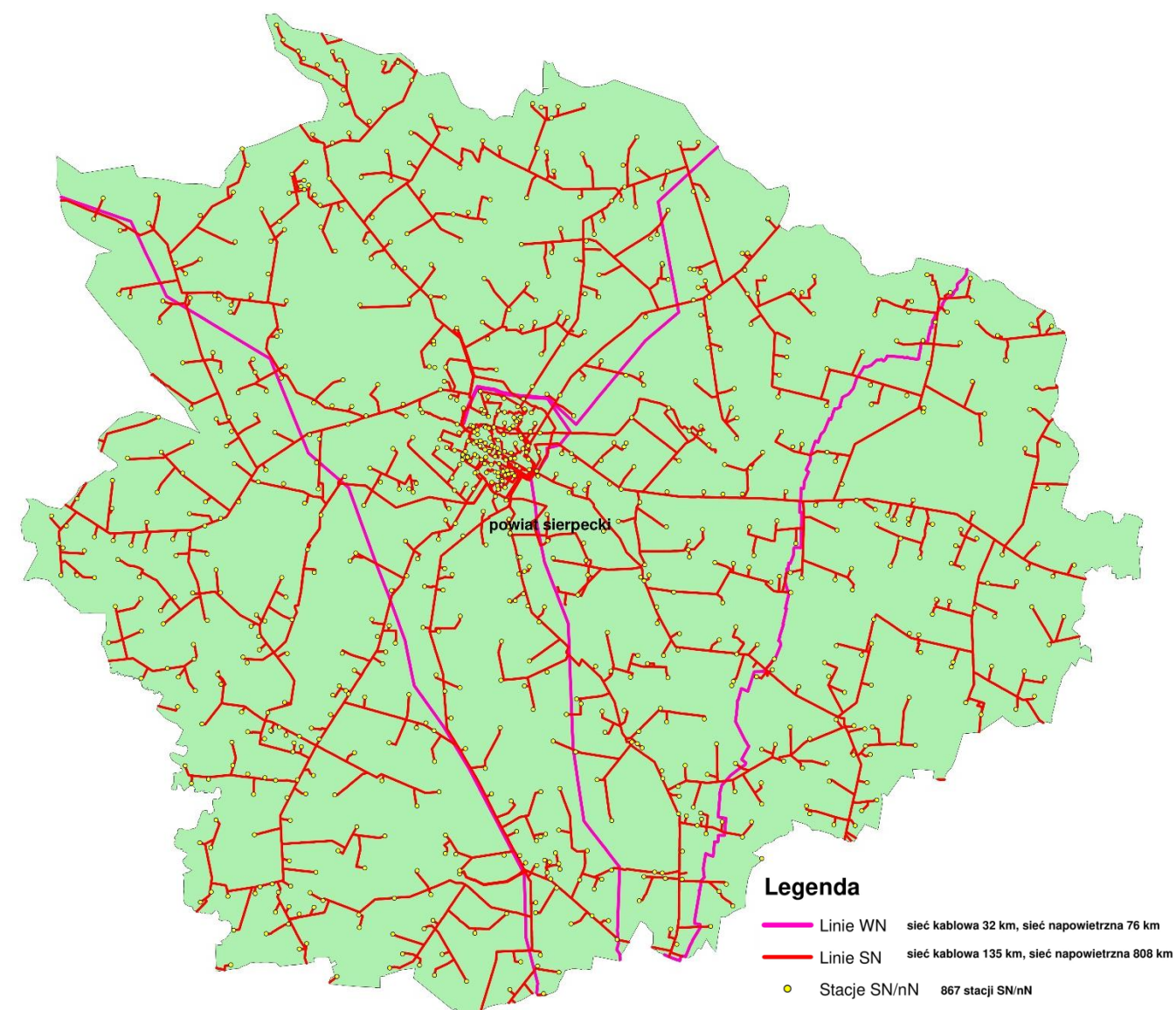
Rysunek 27. Sieć energetyczna na tle powiatu sierpeckiego źródło: ENERGA-OPERATOR SA Oddział w Płocku
